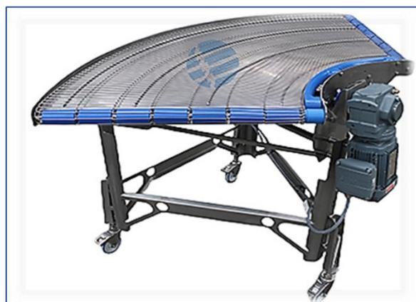
**Le Model 816** est monté avec tapis mailles courbe inox en fil de 1.83mm pas rayon intérieur 7.5mm pas extérieur 20mm.
